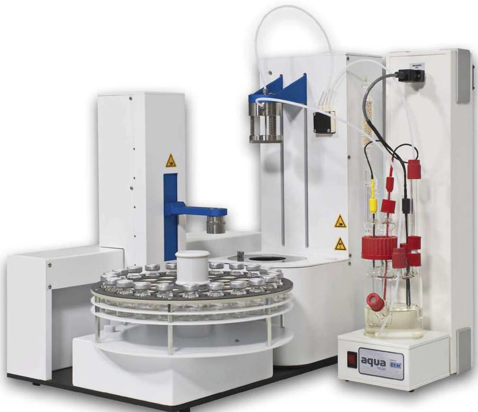
Bild 1: Karl-Fischer-Titrator mit Ausheiztechnik: AQUA 40.00 Vario PLUS (automatisches Gerät mit Autosampler). Bild: ECH Elektrochemie Halle
