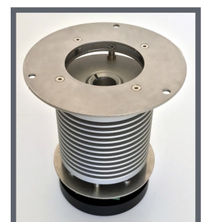
Für verschiedene Vial-Größen: Probenteller und Ofen-Einheit einfach wechselbar
